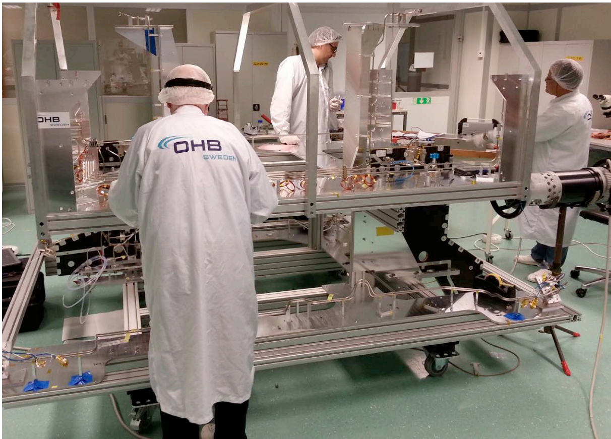
Montage und Test des Leitungssystems für den SmallGEO-Satelliten bei OHB Sweden
