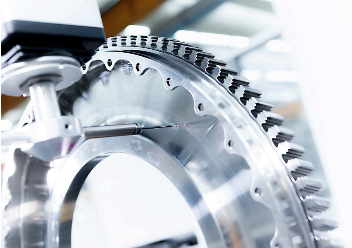
Computergesteuerte Vermessung einer Triebwerksscheibe
